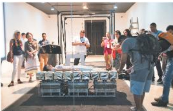
"Martela" é um robô tátil formado por 27 motores subdivididos por três quadros, cada um com nove motores
